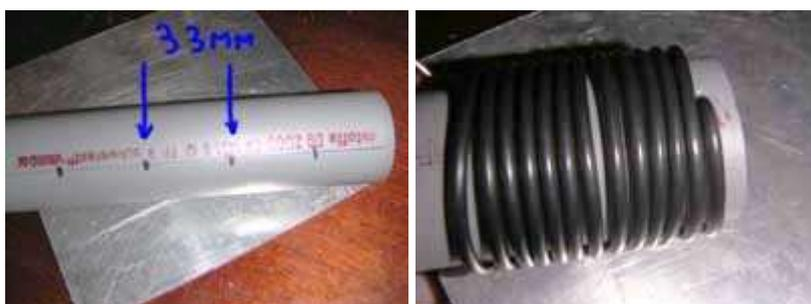
Займемся теперь трубой... как и в случае с пластиной размечаем ее, берем длинную линейку и рисуем линию вдоль трубы, по этой линии отмечаем метки через каждые 33мм от начала трубы (от стороны крепления к пластине) та этих метках должен заканчиваться виток... на последней метки сверлим отверстие (по диаметру провода в изоляции) чтоб зафиксировать провод, наматываем провод на трубу, виток к витку...
