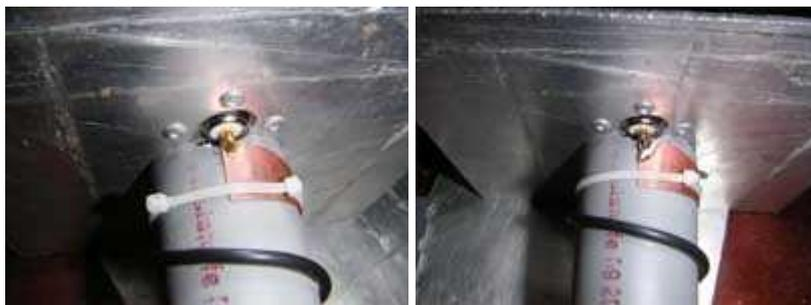
Теперь ответственный момент, пробуем надеть трубу на стакан, примерили? все хорошее ?!! так сейчас будет нужно немного сноровки (умелки, тренировки) нужно приклеить трубу к стакану... клеить будем суперклеем, как вам известно этот клей схватывается очень быстро так что возможности что либо поправить не будет, после приклейки, припаиваем треугольник к разъему... на этом антенна уже работоспособна, осталось дело за малым...
