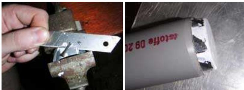
Значит берем вентилятор, вытаскиваем пропеллер, отламываем пропеллеру лопасти, основание доводим до круглого состояния малярным ножом, или другими подручными средствами... напомним что основание должно быть 34мм и он должен точно входить в трубу...
