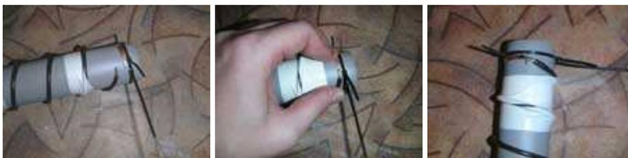
Сгибаем треугольник по окружности трубы... забываем что начало и конец витков должно быть на одном уровне, и треугольник это тоже часть витка, поэтому место подпайки к разъему должно быть на уровне наших отметок и собственно последнего витка. После пайки провода к треугольнику можно заклеивать оставшиеся витки
