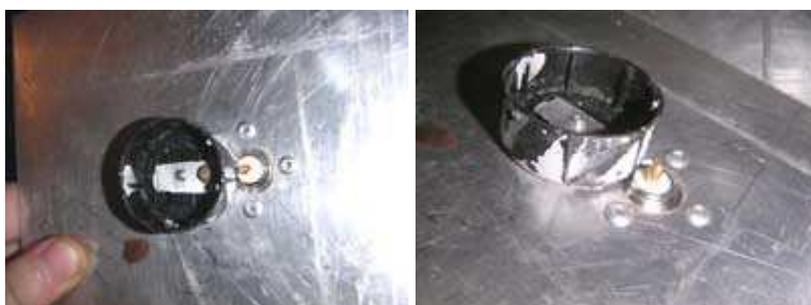
Сверлим по центру стакана (который сделали из кулера) отверстие под клепку (3,2мм) и приклепаем стакан к центру пластины через шайбу (как видите у меня это алюминиевая полоска), после чего, второе отверстие, которое мы оставили, просверливаем сквозь стакан и шайбу, крепим болтом (длинной клепки на тот момент у меня не оказалось)
