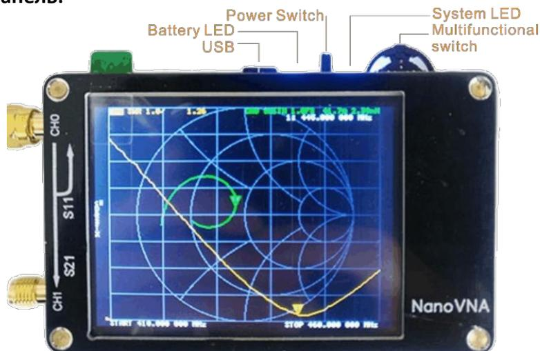
Интерфейс USB используется для подключения к ПК или стандартному зарядному устройству напряжением 5V.
