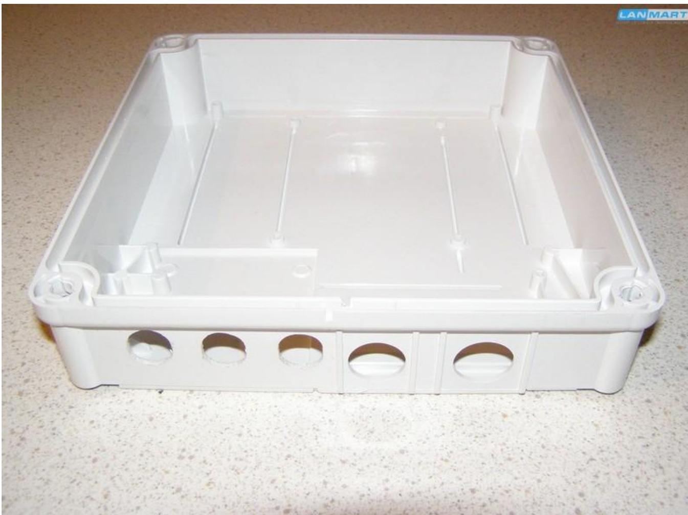
Поэтому придется просверлить 3 отверстия самостоятельно. При этом сверло нужно использовать меньшего диаметра, чем разъем пигтейла, и далее напильником разработать отверстия до придания им овальной формы. Что позволит надежно зафиксировать пигтейл от проворачивания.
