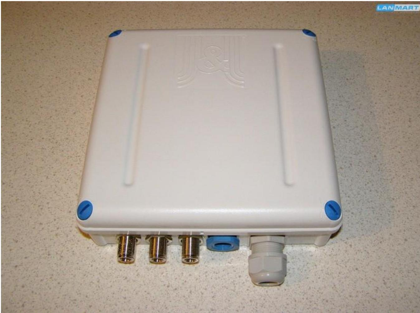
Одеваем ее сверху на нижнюю часть корпуса и поворачиваем плоской отверткой замочки до щелчка. Получилось удобное готовое решение для размещения на мачте и подключения антенн с использованием ВЧ кабелей на базе корпуса **Jirous Gentle BOX JE-200**.
