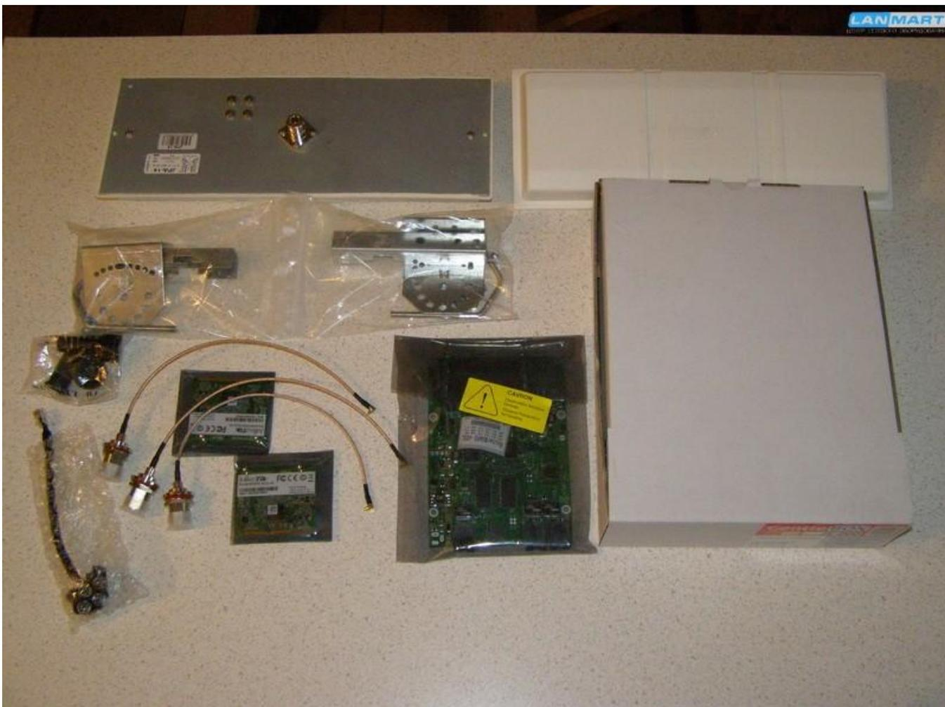
Плата Mikrotik RB433L, 2 радиокарты R52n-M, 3 пигтейла N-Type-MMCX, корпус Jirous JE-200, 2 секторных антенны Jirous JPA-14 и гермоввод.
