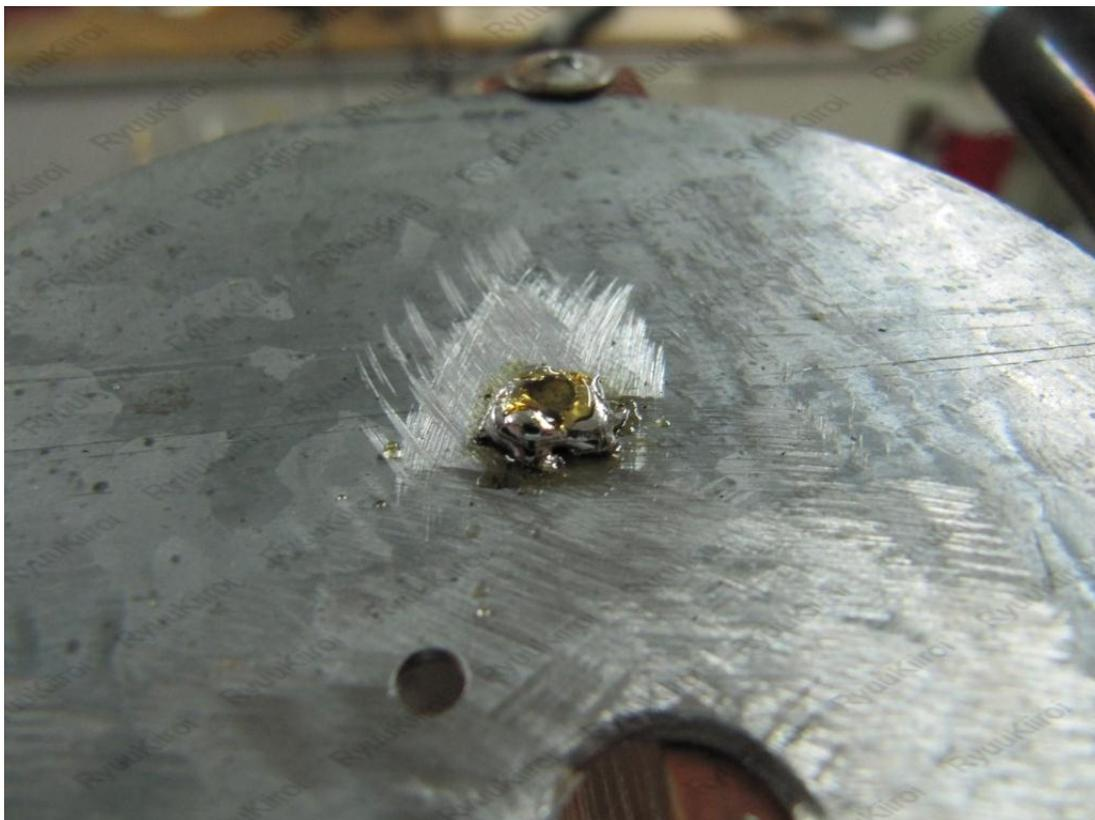
И нагреваем чем либо, чтобы припой растекся. Я нагреваю автогенкой. Также можно феном или мощным паяльником. Если припой затечет между стержнем и рефлектором, то пайка удалась.
